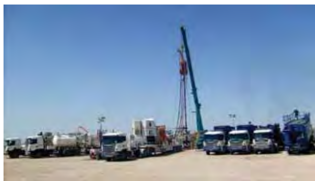
Figura 1. Unidad de CT y equipos periféricos utilizados en la completación del pozo.
