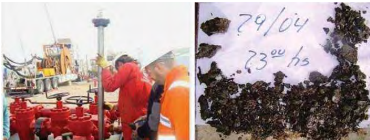
Figura 12 (izquierda). Dispositivo Debris Catcher utilizado en la operación de rotado; (derecha) recortes de los tapones extraídos durante la operación.
