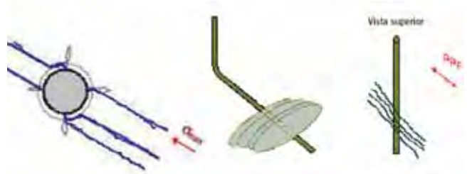
Figura 3. Tortuosidad y generación de múltiples fracturas. Efecto de alineación de PPF respecto a punzados con generación de tortuosidad y múltiples fracturas. Pozos dirigidos en formaciones duras como FM Choiyoi son propensos a mostrar excesivas múltiples fracturas.
